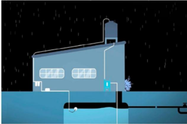
La captación se compondrá de una superficie impermeabilizada destinada para la cosecha del agua de lluvia y la recolección del agua por medio de canaletas o dispositivos que recolecten y entreguen el agua captada hasta el inicio de la tubería de conducción
